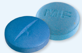
DEFECTOS DE GRABADO
