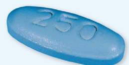
DEFECTOS DE GRABADO
