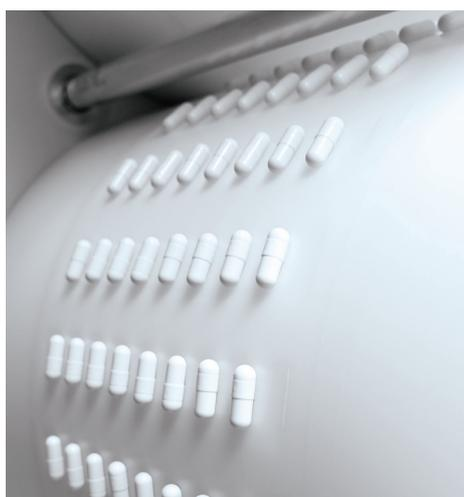
*SPINE FIBO implementa una manipolazione controllata di ogni prodotto che consente un'ispezione visiva al 100% e un conteggio preciso prima del riempimento dei flaconi*
